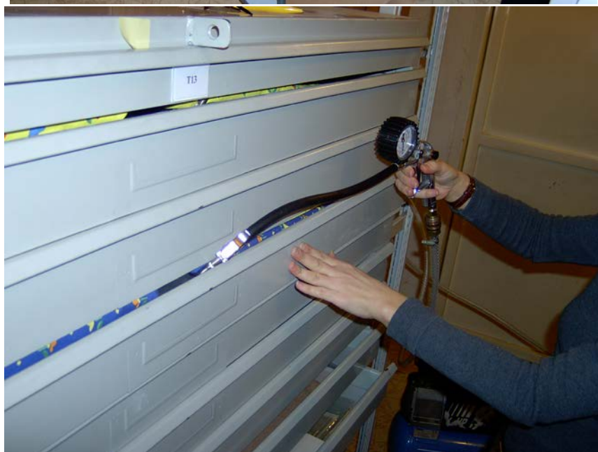
18–19. kép. Az építészeti tervek rögzítése a felfújható tömlőkkel (BFL XV.19.c.4)
